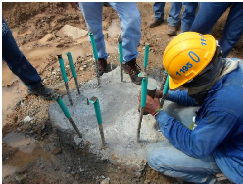
Figura 4. Golpe del martillo sobre la superficie del concreto
