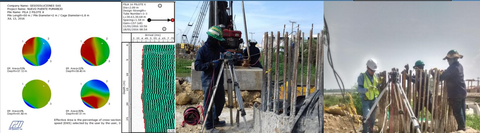
Una de las principales ventajas de este ensayo es la obtención de perfiles 2D de los pilotes donde se puede observar posibles afectaciones en la calidad de estos elementos. El equipo con el que se cuenta tiene las siguientes características:
