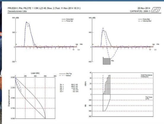
Una vez recolectadas las señales de fuerza y velocidad mediante los sensores, estas se procesan mediante el software CAPWAP®, lo que permite determinar la resistencia estática esperada del suelo de fundación.
