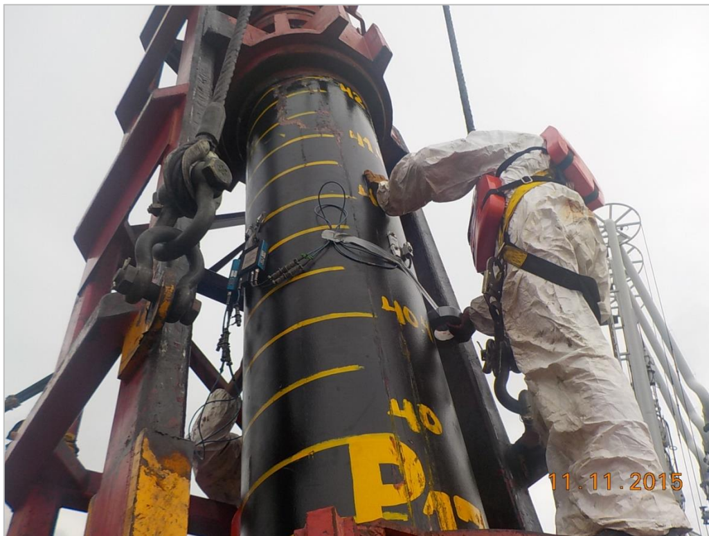
Figura 3. Par de sensores instalado (deformímetro – acelerómetro)
